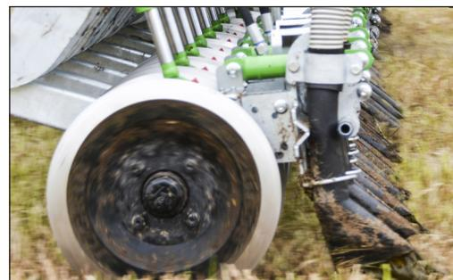
*Nouvelle disposition du tuyau dans le manchon et nouvelles pincettes hydrauliques*
